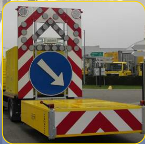
Atenuador Móvil para vehículos Acorde a Normativa NCHRP350 (TL2 y TL3) . (Video de demostración en Youtube)
