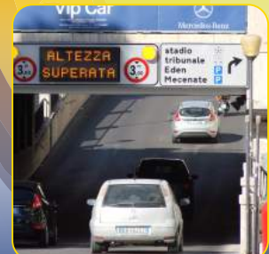
Advertencia con Luminosos Panel de Mensaje Variable y Focos o Señal LED
