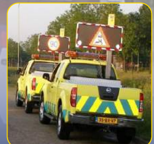
Panel de Mensaje Variable LED 80x32x12 Fabricado en aluminio, full color MASTIL HIDRAULICO (Video de demostración en YouTube)
